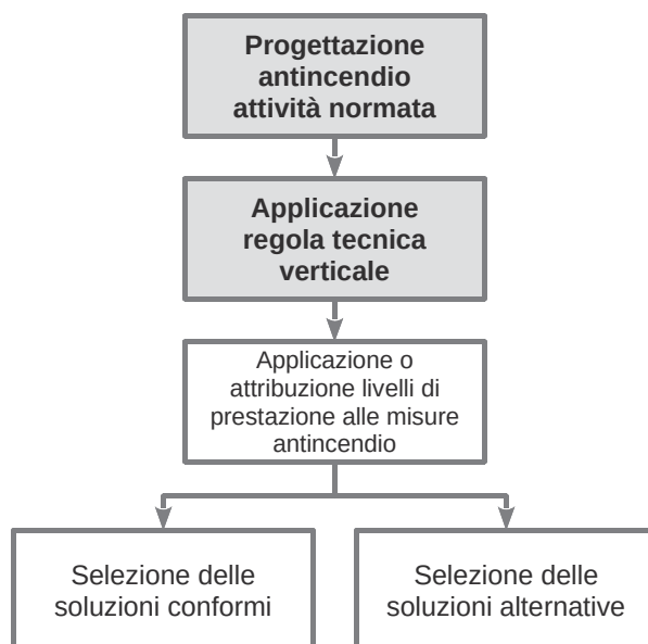
Illustrazione G 2.3: Progettazione antincendio delle attività normate
